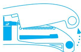
Para cambiar la hoja, **presione el botón** ubicado en el extremo del cúter y abra la mitad superior del mango.
